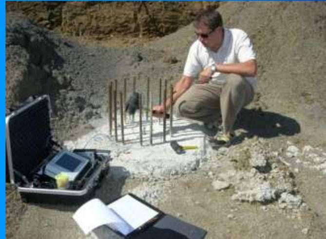
L'utilizzo del martello strumentato è raccomandato per il controllo di pali di piccolo e medio diametro, mentre per i pali di grande diametro, al fine di applicare una sufficiente energia cinetica per mettere in vibrazione il palo, è necessario utilizzare la vibrodina.
