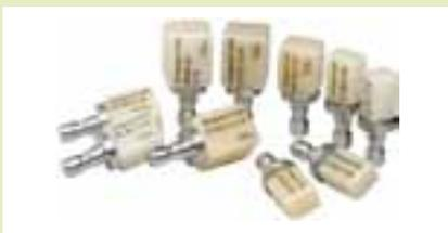
Blocchetti in vetroceramica rafforzata con leucite per la tecnica CAD/CAM. Oltre alle caratteristiche foto-ottiche, questi blocchetti in ceramica si distinguono per la loro resistenza alla flessione biassiale media di 185 MPa. I restauri IPS Empress CAD entusiasmano per la loro trasparenza naturale e per la convincente estetica. Confezione: 5 pezzi.
