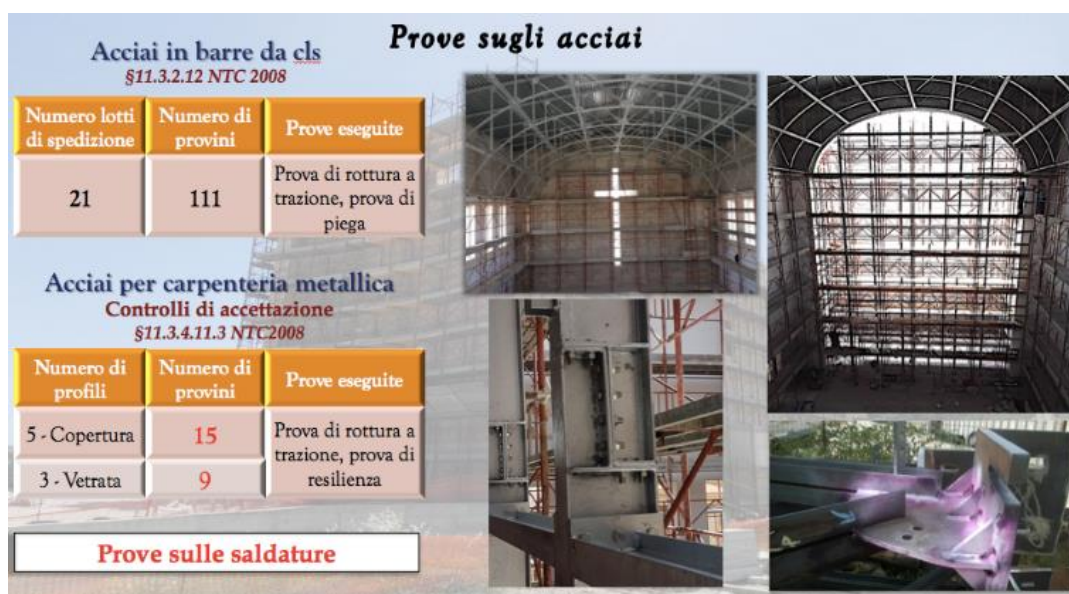
Figura 9 – Quantificazione delle prove sugli acciai
