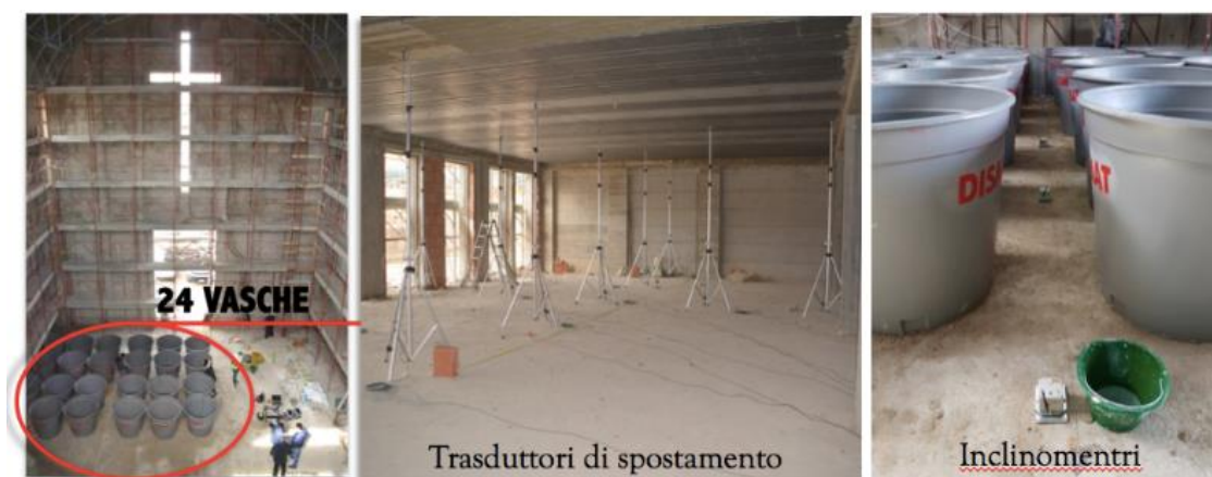
Foto 10 – Fasi preparative della prova
