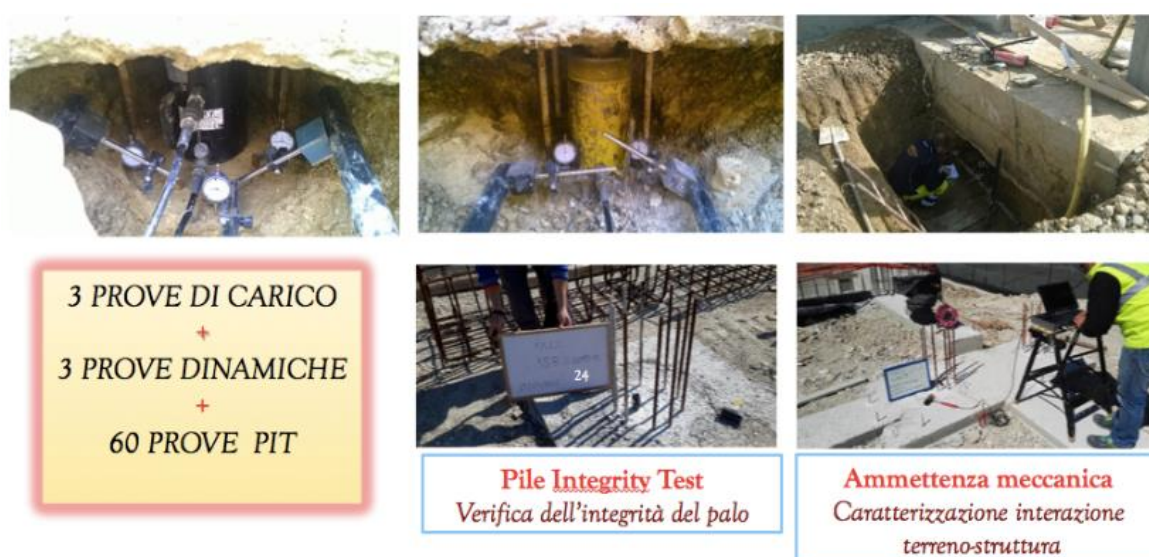
Figura 10 – Tipologia di prove sui pali di fondazione
